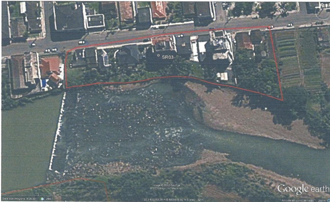
**Descrição:** Ocupação urbana na margem do Rio Manoel Alves, formado por sedimentos fluviais arenosos interdigitados com depósitos conglomeráticos. Margem com processo de erosão fluvial instalado, afetando grande parte dos lotes de prédios e edifícios. Presença de pequenos abatimentos na estrutura de aterros, pisos, muros e cercas. Eventos registrados em 1995, 2009, 2010 e março/2012.
