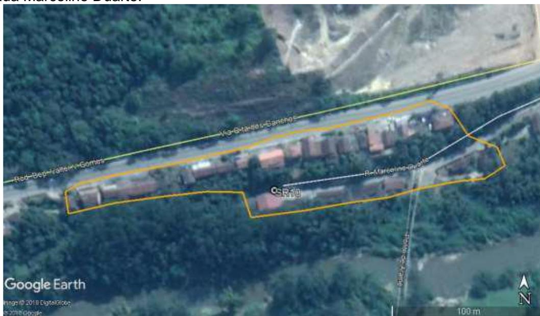
**SC\_SAOJOAO\_SR\_11\_CPRM** - Setor de muito alto risco a deslizamento planar em solo/ solapamento/ rolamento de blocos entre a Rodovia Dep. Gentil Battisti Archer e a margem esquerda do rio Alto Braço.
